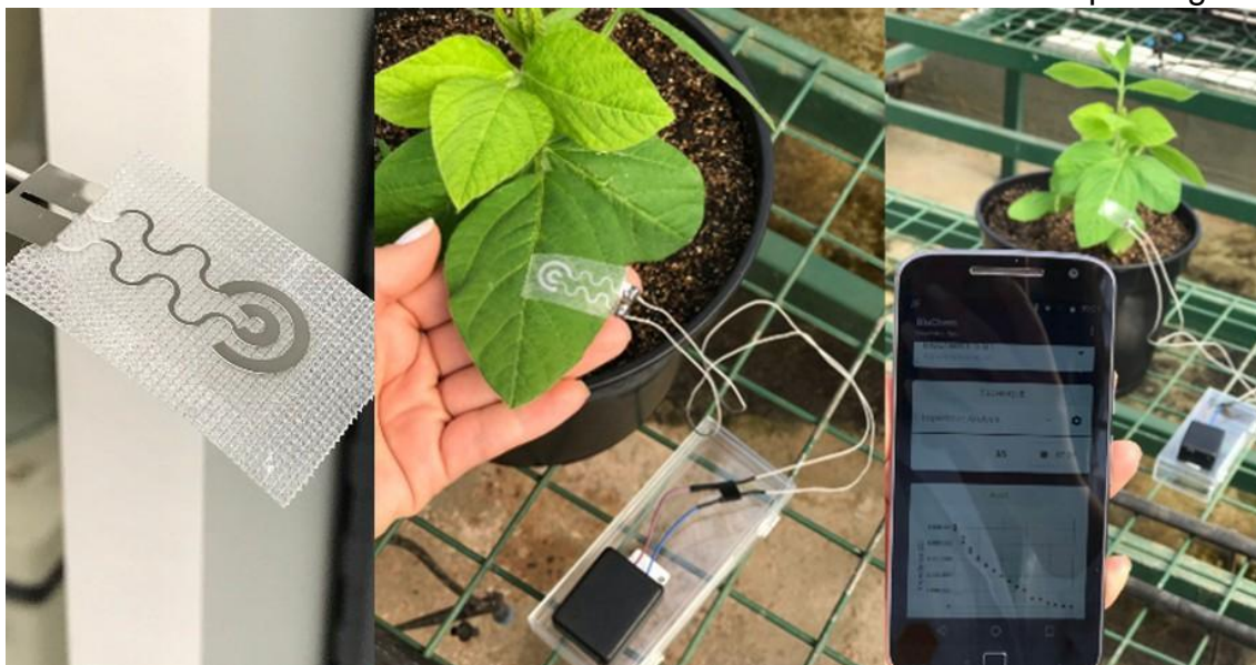
Figura 10. Sensore fogliare per il rilevamento della perdita d'acqua. Fonte: Um Só Planeta
