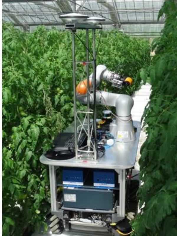
Figure 17 . Distributeur automatique Green Patrol pour la lutte contre les parasites. SmartProtect
