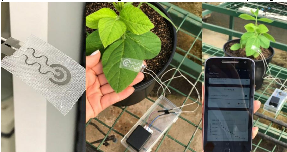
Figure10 . Capteur foliaire pour la détection des pertes d'eau. Source : Um Só Planeta
