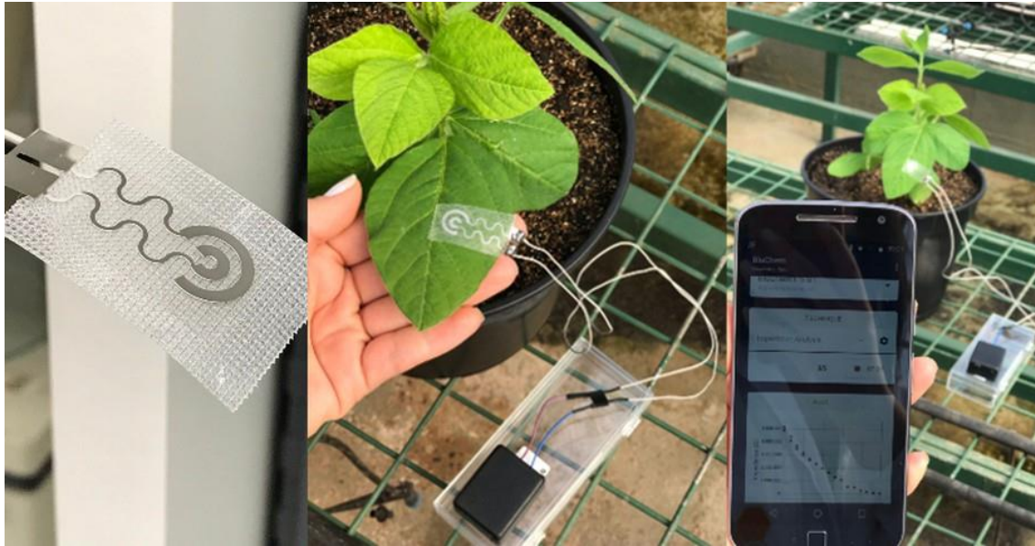
Figura 10. Sensor folial para detección de pérdida de agua. Fuente: Um Só Planeta
