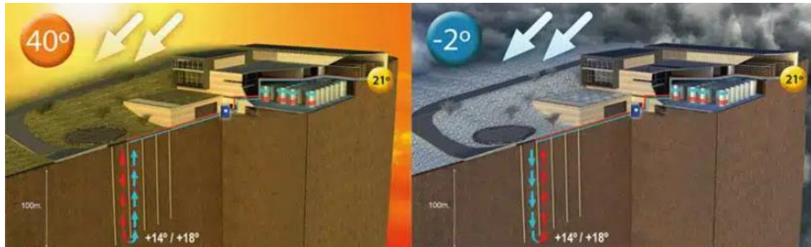
Figura 19. Impianto geotermico presso la cantina Château Smith Haut Lafitte Fonte: VitiViniCultura
