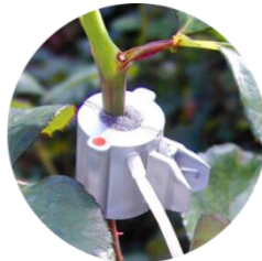
Figura 4. Sensore di flusso della linfa. Fonte: Agronic
