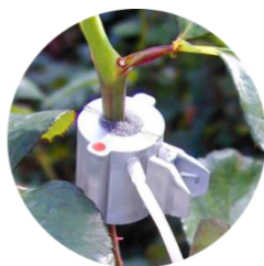
Figura 4. Sensor de flujo de savia. Fuente: Agronic
