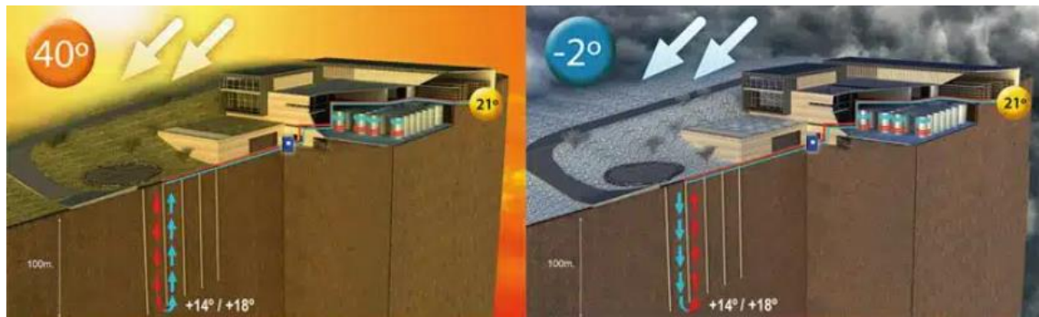
Figura 19. Instalación geotérmica en la bodega Château Smith Haut Lafitte Fuente: VitiViniCultura
