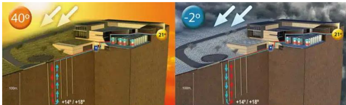
Figure 19. Installation géothermique au domaine viticole Château Smith Haut Lafitte Source : VitiViniCultura
