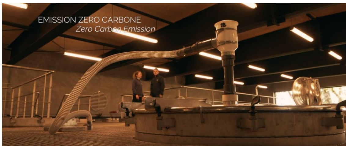
Figure 12. Collecteur de CO 2 pour les processus de fermentation. Source : Château Smith Haut Lafitte
