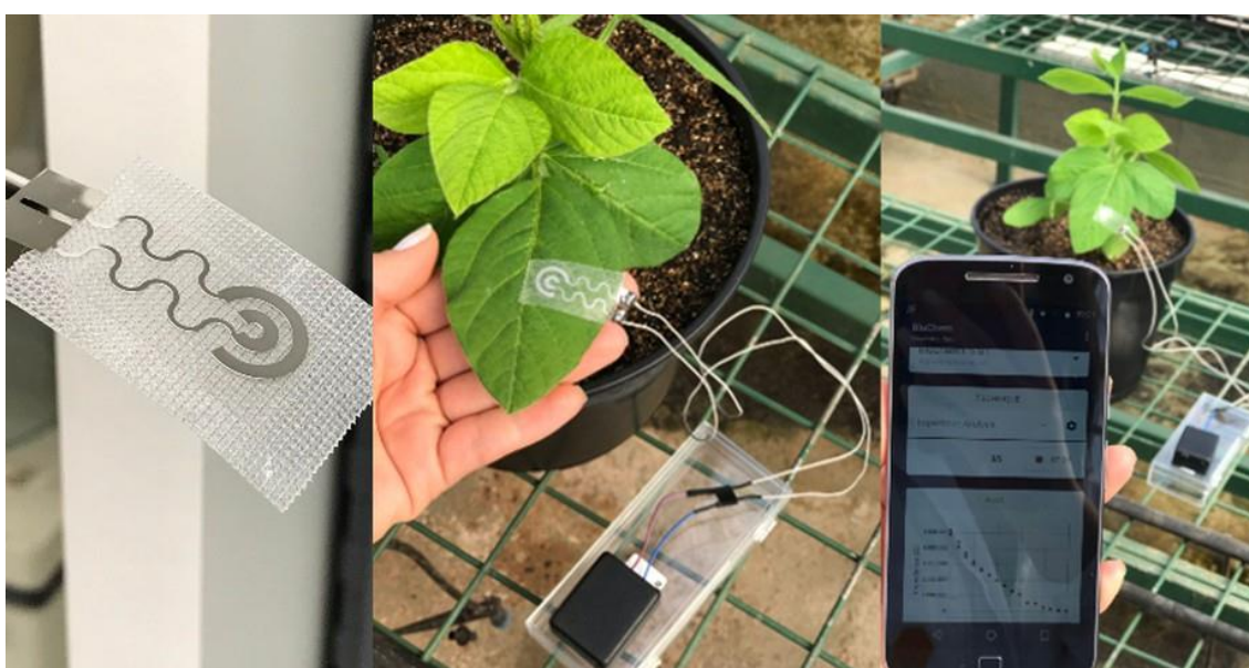
Slika 10. Folijarni senzor za detekciju gubitka vode. Izvor: Um Só Planeta
