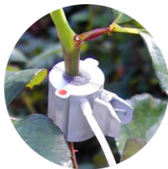
Slika 4. Senzor protoka soka. Izvor: Agronic
